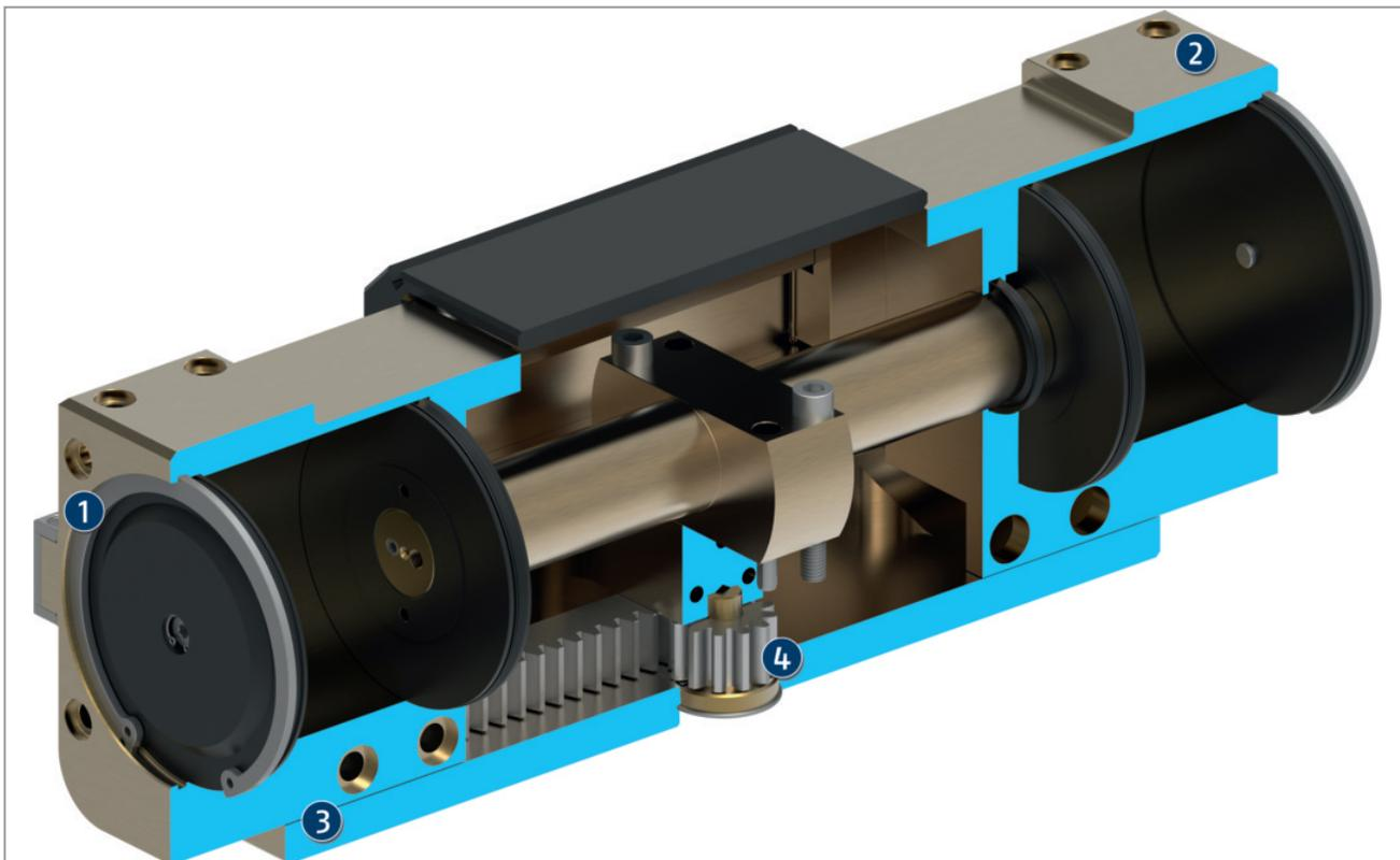
Расположенные соосно базовые губки приводятся в движение сжатым воздухом непосредственно с помощью закрепленного поршня, который открывает и закрывает их. Движение базовых губок синхронизирует реечный механизм. Непосредственная передача усилия обеспечивает высокую степень эффективности и, следовательно, очень большие усилия захвата.
