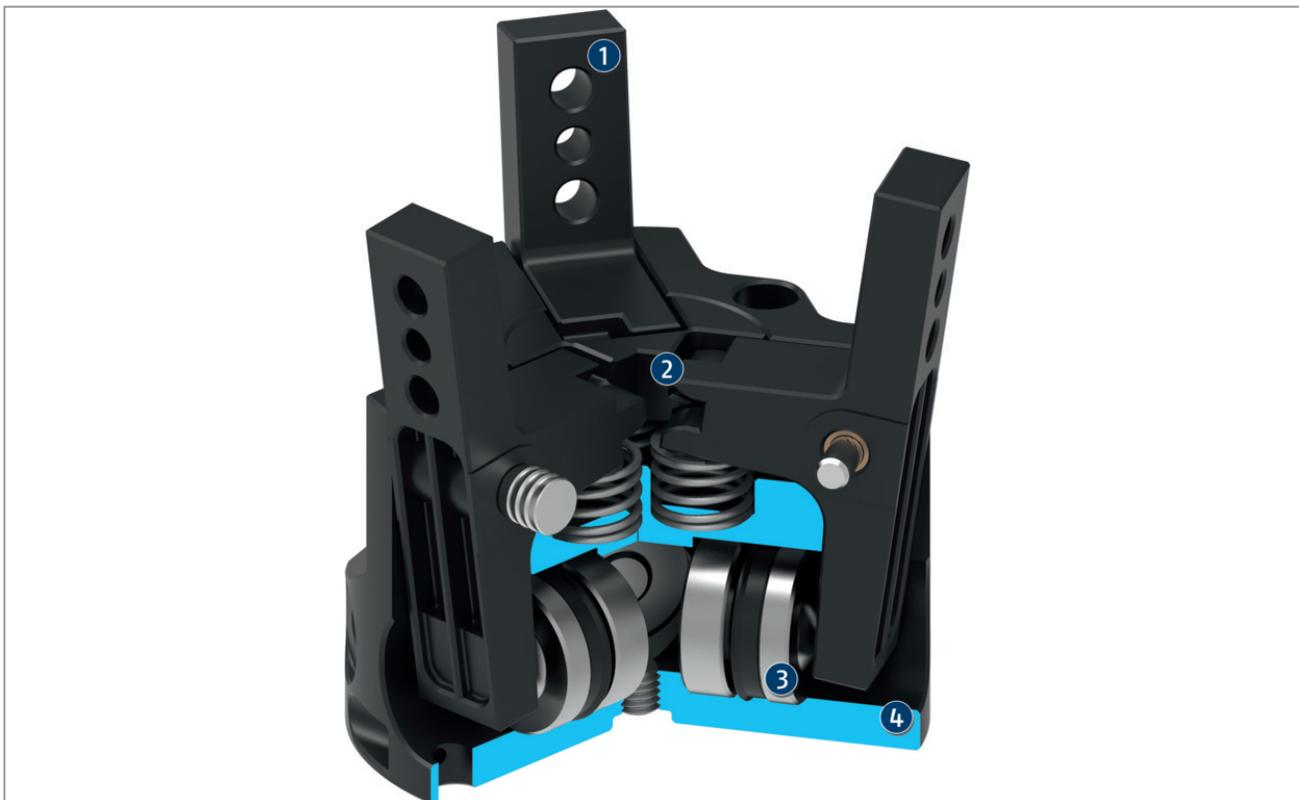
Расположенные горизонтально поршни расталкиваются сжатым воздухом. Базовые губки синхронно открываются на нужный угол с помощью рычагов с подшипниками. Возврат осуществляется под действием пружины сжатия.
