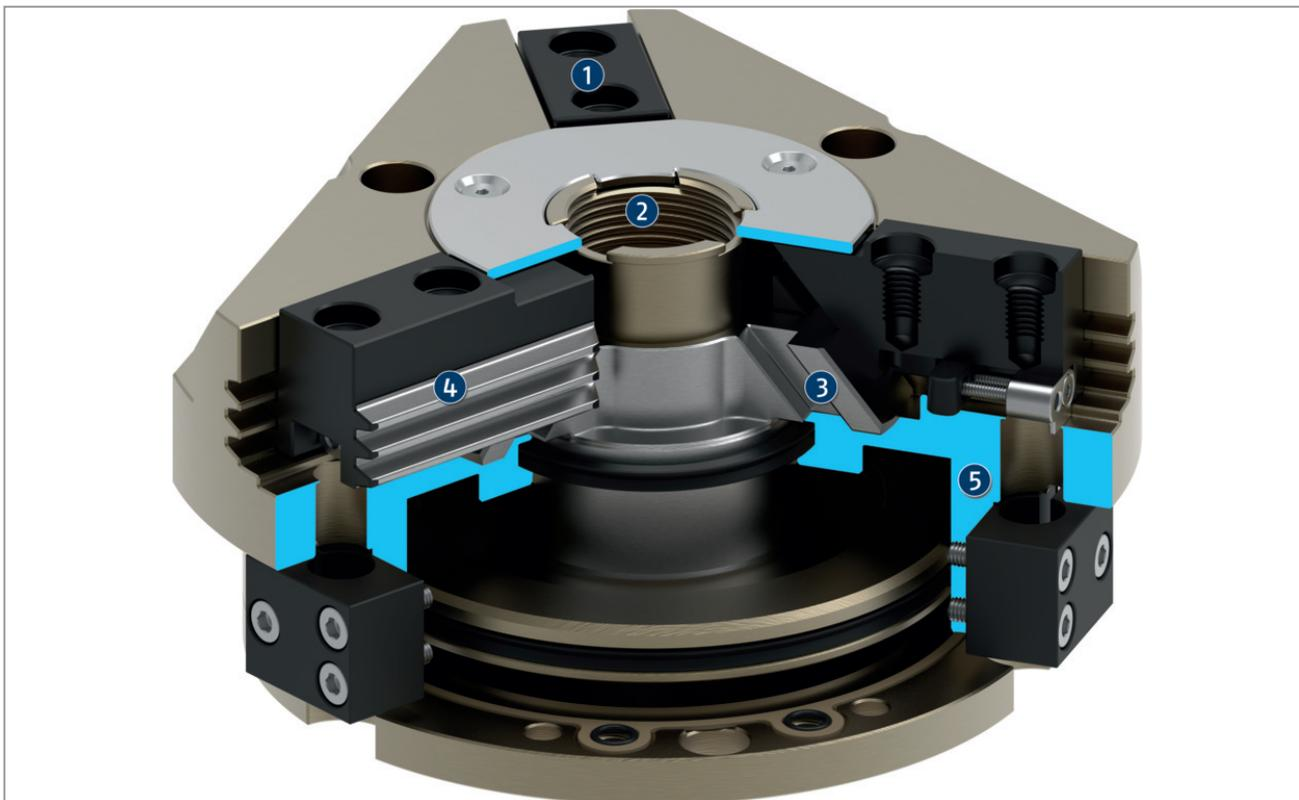
Поршень перемещается вверх и вниз под действием сжатого воздуха. Наклонные рабочие поверхности клинового механизма обеспечивают синхронное центрирующее перемещение губок.
