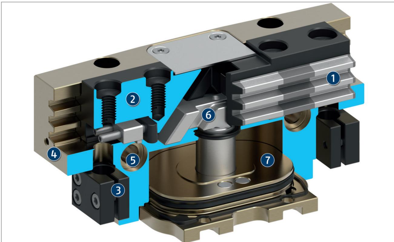
Поршень перемещается вверх и вниз под действием сжатого воздуха. Наклонные рабочие поверхности клинового механизма обеспечивают синхронное параллельное перемещение губок.
