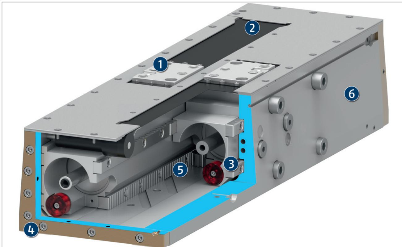
Базовые губки работают как подвижные цилиндры, в то время как сами поршни остаются неподвижными. При подаче давления на противоположный поршень базовые губки приходят в движение. В конце хода губки демпфируются эластомерными подушками.
