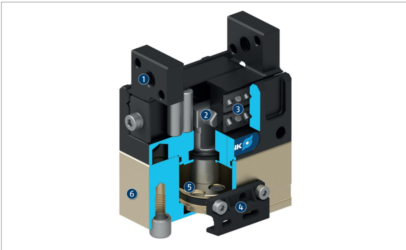
Овальный поршень перемещается вверх и вниз под действием сжатого воздуха. Наклонные рабочие поверхности клинового механизма обеспечивают синхронное параллельное перемещение губок.
