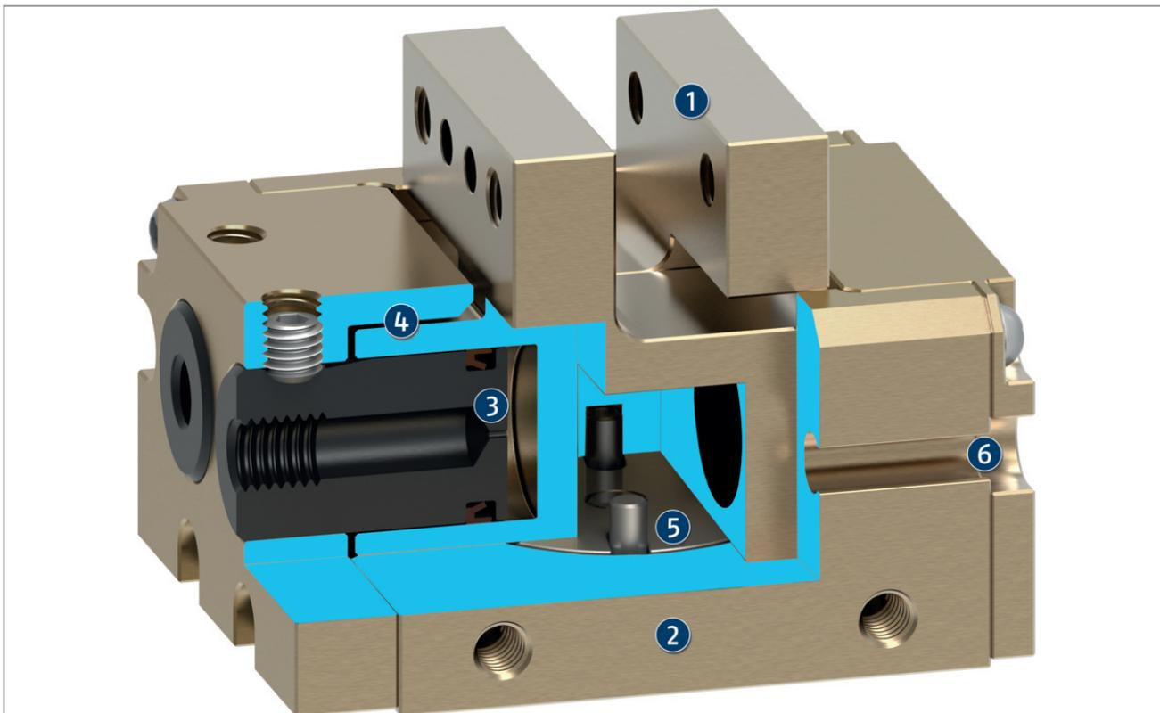
Базовые губки приводятся в действие сжатым воздухом через неподвижный поршень, за счет чего открывается или закрывается захват. Кинематика синхронизирует движение базовых губок.
