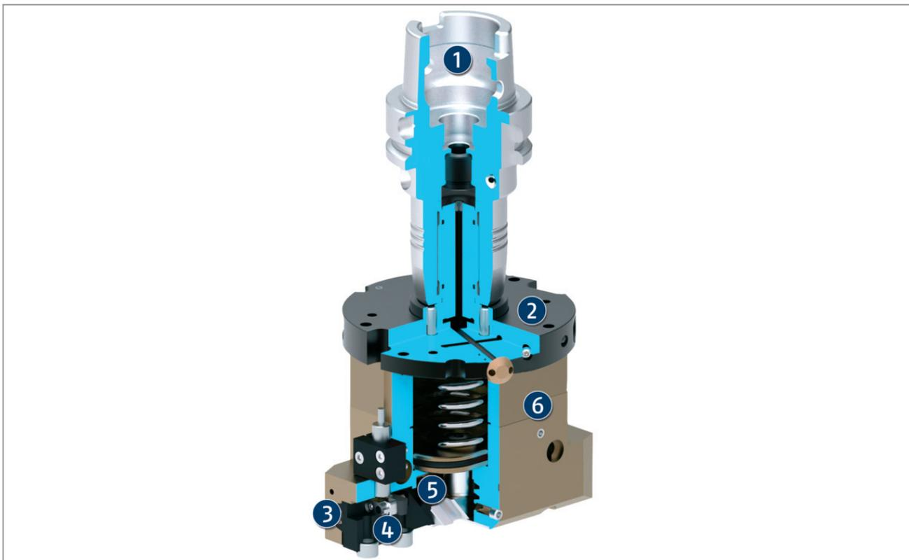
Давление, создаваемое централизованной системой подачи смазочно-охлаждающей жидкости станка, понижается в распределителе давления, интегрированным в адаптерные плиты. После этого захват может быть приведен в действие и, в свою очередь, привести в действие базовые губки посредством поршня и клинового механизма. Во время работы захват постоянно подает смазочно-охлаждающую жидкость или сжатый воздух через боковой клапан управления давлением.
