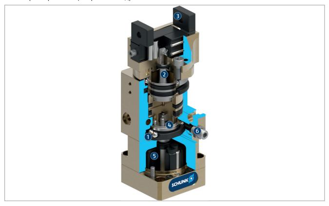
Поворотный привод вращает встроенный захват путем подачи давления со стороны ротора. Он приводится в движение собственным поршнем. Движение поршня, в свою очередь, преобразуется в синхронное движение захвата.
