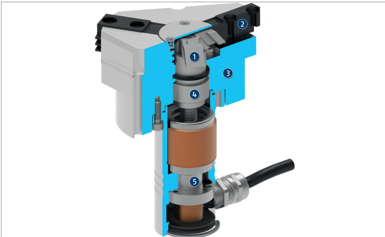
Ходовая гайка, установленная на подшипниках, преобразует вращение серводвигателя в осевое перемещение. Наклонные поверхности клинового механизма заставляют губки двигаться синхронно.
