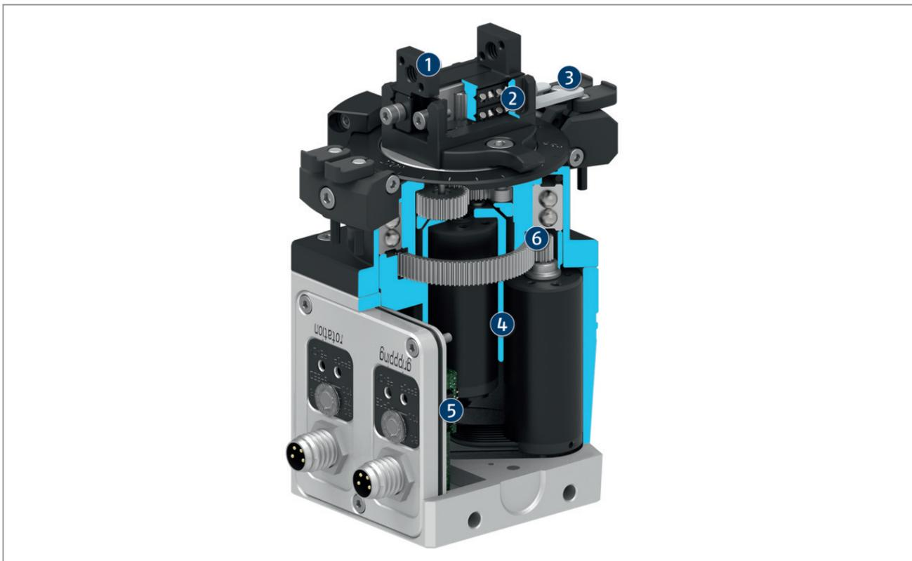
Захватно-поворотный модуль оснащен двумя стационарными приводами с бесколлекторными серводвигателями. Расположенный снаружи двигатель вращает захват. Внутренний двигатель приводит в движение базовую губку захвата. Движение губок синхронизирует реечный механизм.
