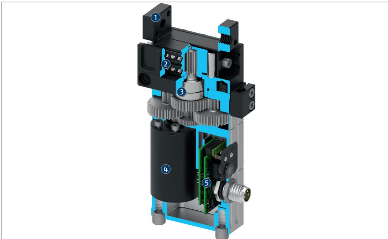
Бесколлекторный серводвигатель через зубчатый механизм приводит в движение базовую губку. Движение базовых губок синхронизирует реечный механизм.
