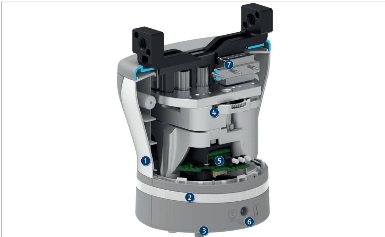
Многоступенчатая зубчатая передача приводится в действие бесколлекторным серводвигателем. Базовые губки захвата приводятся в действие тремя параллельными вторичными шестернями, оснащенными зубчатыми рейками. Таким образом, губки приводятся в действие реечным механизмом, преобразующим вращательное движение серводвигателя и редуктора в поступательное движение базовых губок.
