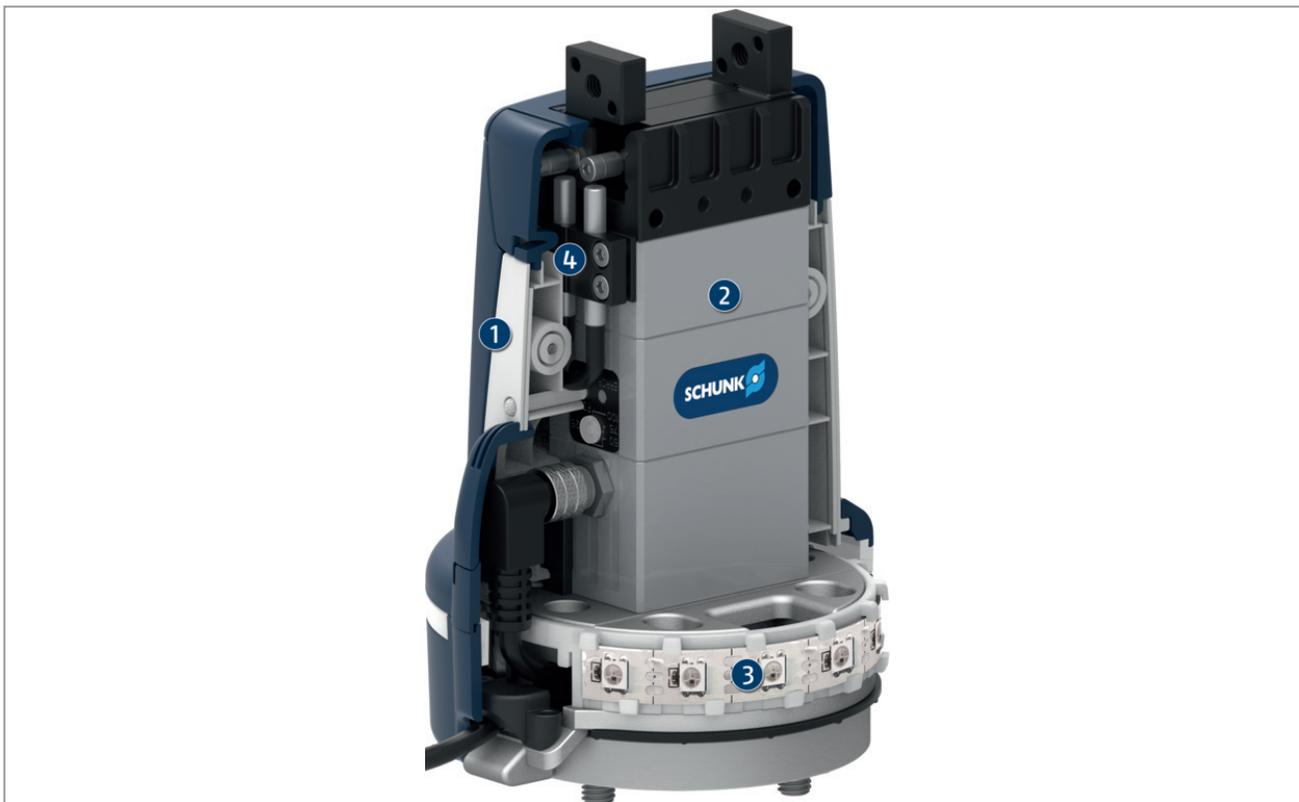
Захват Co-act EGP-C приводится в действие электричеством и имеет встроенный ограничитель тока и крышку для защиты от столкновений. Ограничитель тока гарантирует то, что усилие захвата не превысит заданное значение. Защитная крышка служит для уменьшения риска травм от столкновений при выполнении совместных операций "человек-робот".
